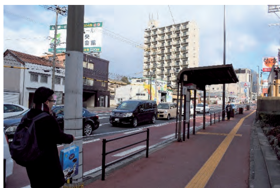
写真 13 防護柵や電柱が支障となるバス停
