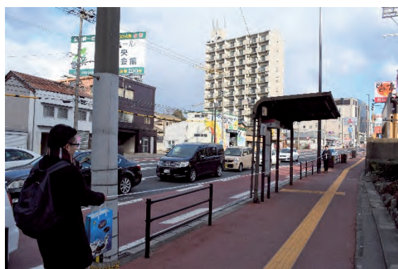
写真 13 防護柵や電柱が支障となるバス停
