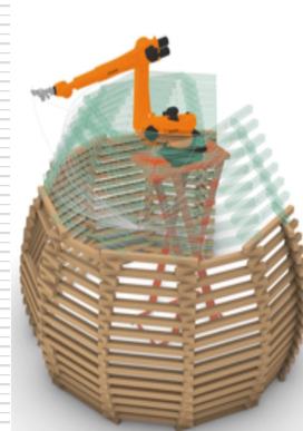
アーム型ロボットによる積層木造ドーム
