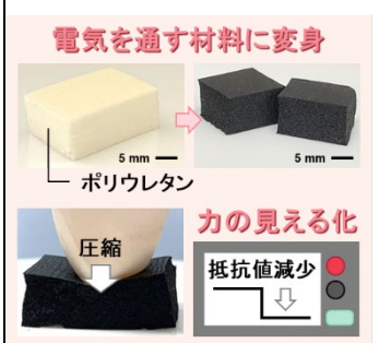
図1 ゴムを構成する高分子鎖のすき間での導電性高分子の合成と力の見える化
